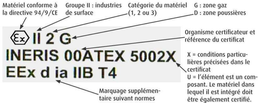
Figure 46 : Exemple de marquage CE d'un matériel
